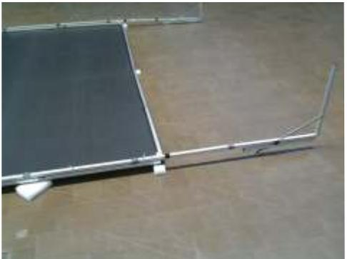
Alle Schrauben und 4x Eckarretierungen nochmals kontrollieren! Leinwand hochziehen und alle 4 Fussstützen ausklappen.
