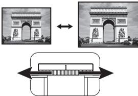
2. Machen Sie das Bild schärfer, indem Sie am Fokusring drehen.
