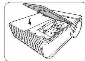
11. Ziehen Sie die Befestigungsschraube der Lampenabdeckung an.
