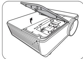
4. Lösen Sie die Befestigungsschrauben der Lampe.
