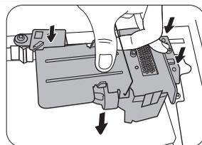
8. Ziehen Sie die Befestigungsschrauben der Lampe an.
