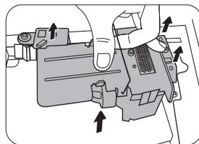
7. Setzen Sie, wie in der Abbildung gezeigt, die neue Lampe ein.
